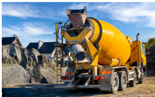
Transportul și malaxarea betonului până la punctul de lucru
